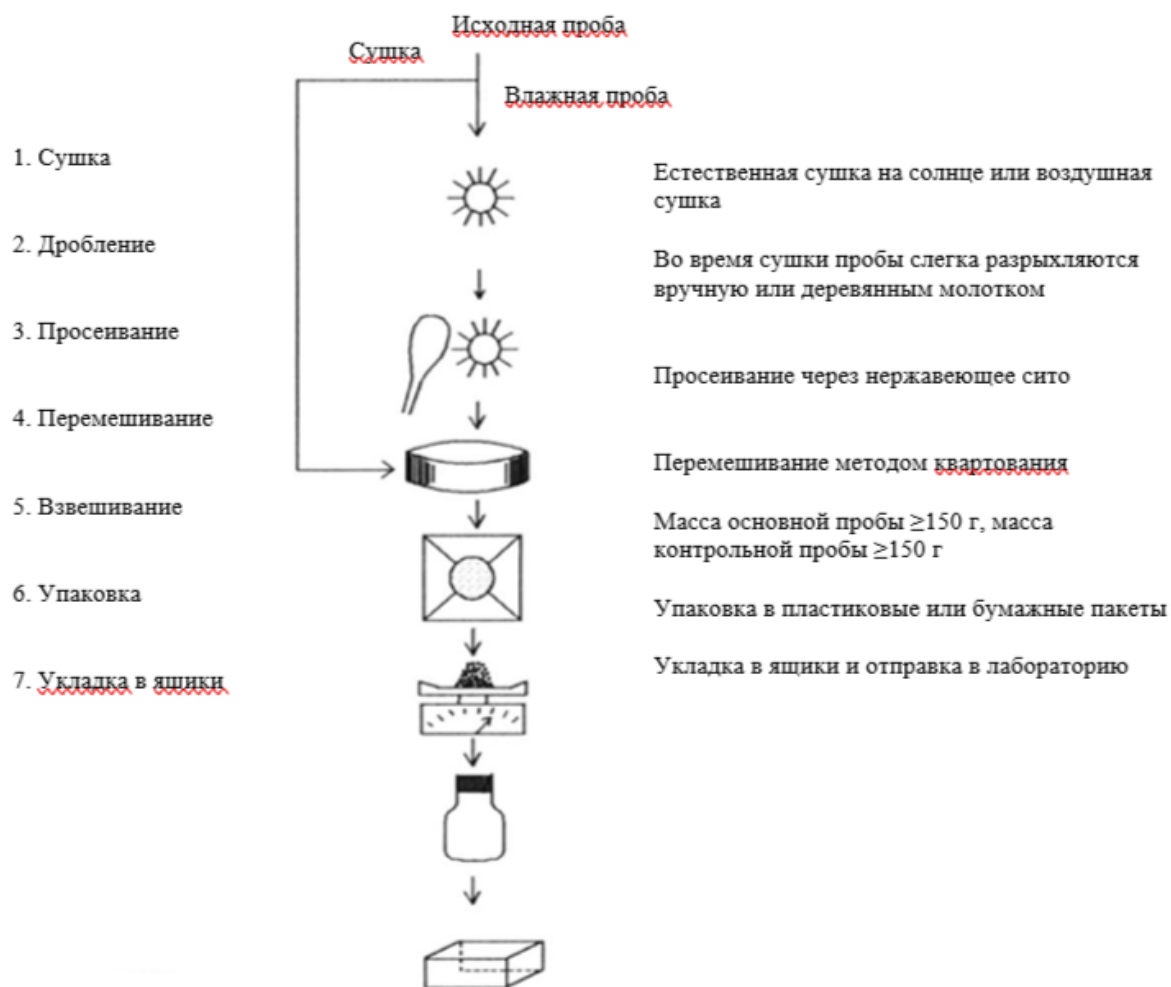
рисунк 5-4-5 Схема технологического процесса обработки полевых проб
