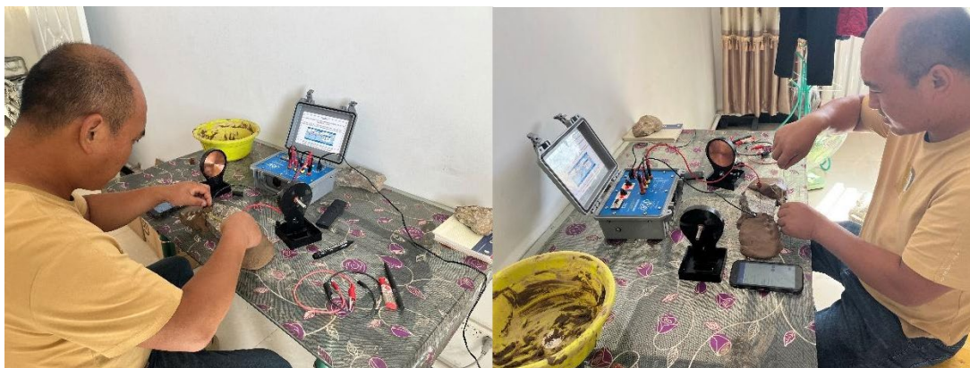
Рис. 5-4-4б Практическое измерение электрических параметров образцов методом грязевой ванны
